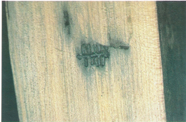
Figure 63 – Coloration du bois associée aux galeries ramifiées d'un scolyte du bois, un insecte qui attaque fréquemment l'érable à sucre.
