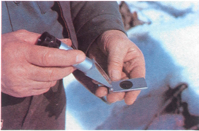
Figure 3 – Réfractomètre à la position ouverte, servant à mesurer la concentration en sucre de la sève.
